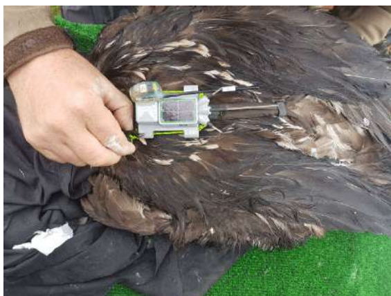
Ilustración 6. EOBs, modelo Bird Solar GPRS 90 grs.
